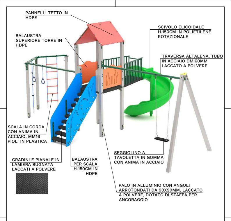
TUTTI GLI ELEMENTI DI FISSAGGIO, VITI, DADI, RONDELLE ECC. SONO IN ACCIAIO ZINCATO E PROTETTI DA GHIERE E TAPPI IN POLIETILENE.
